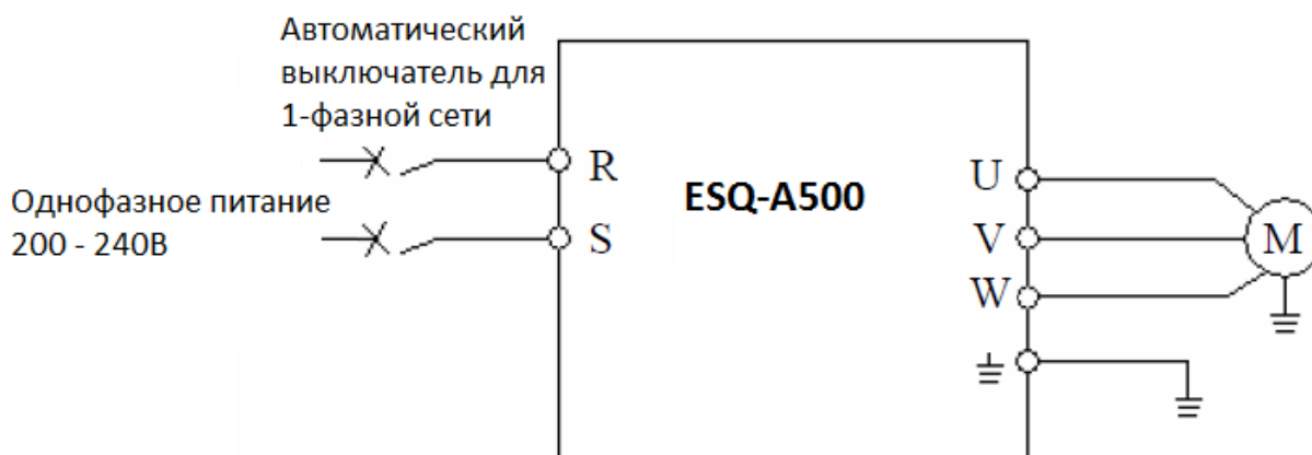
Рисунок 2. Однофазная схема подключения мотора к ЧП
